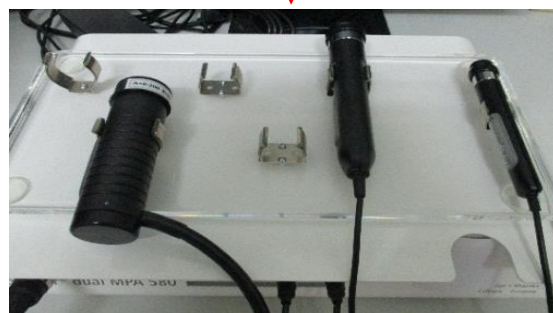
รูปที่ 2 Mexameter probe, Corneometer probe และ Cutometer probe ที่ต่อกับเครื่อง Cutometer MPA 580
