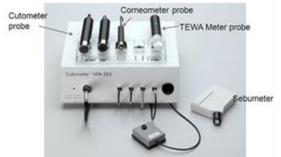
รูปที่ 2 เครื่อง Cutometer MPA 580 ที่มีด้วย TEWA Meter probe, Corneometer probe, Cutometer probe และ Sebumeter
